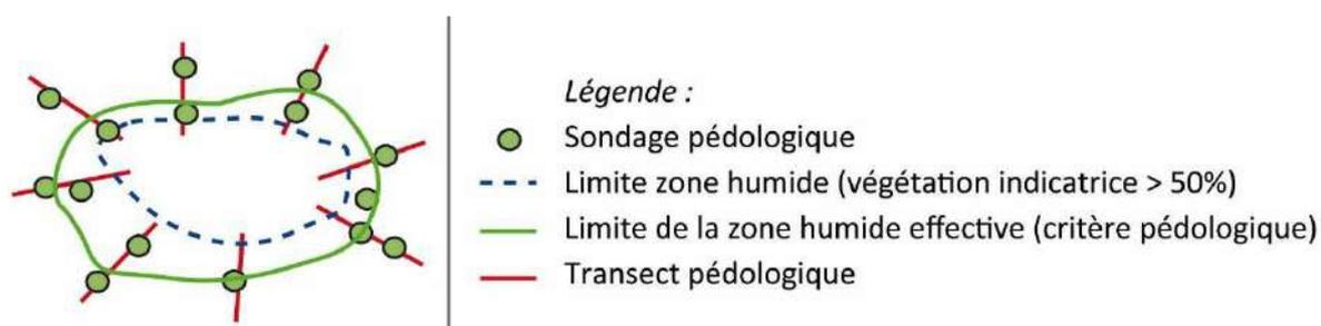
A ce principe méthodologique, s'ajoute la prise en compte des éléments du paysage, à savoir la topographie, et des éléments d'hydrologie locale qui conduisent souvent à une modification des conditions hydrodynamiques du secteur.
